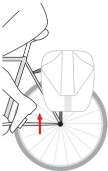
**Zum Einstellen der Taschenposition** Schrauben im Haken leicht lösen. Bitte unbedingt darauf achten, daß genügend Abstand zwischen Tasche und Pedal bleibt. Schrauben wieder festziehen. Die Tasche am Gepäckträger einhängen. Beide rote Riegel nach unten drücken und unter die Gepäckträgerstrebe schwenken.
