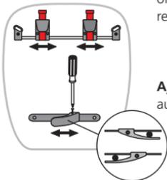
**Ajuster la position horizontale** des crochets au porte-bagages! Merci de noter qu'il doit y avoir un espace suffisant entre les sacoches et les pédales. Placer les sacoches sur le porte-bagages, et verrouiller les deux crochets rouges comme le dessin le montre.
