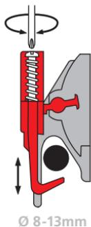
Die **KLICKfix-Schiene** ist individuell einstellbar auf Träger von Ø 8-13mm. Die Haken **1** sind mit Federelementen ausgerüstet – für festen Sitz auf 8mm Streben. Bei Gepäckträgern Ø 9-13mm die Feder mit einem Schraubendreher abbrechen. Rote Taste **2** mit der Einstellschraube auf den Durchmesser des Gepäckträgers anpassen.
